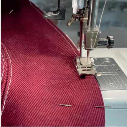
Stecken Sie die Öffnung mit Stecknadeln zusammen. Achten Sie darauf, die Rundung bei der Öffnung beizubehalten.
